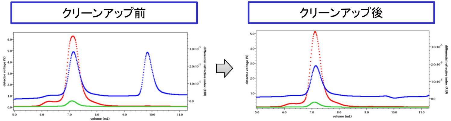
(上図) Proteus Detergent EXカラムを使用したシアロバクテリアのPSII複合体試料の0.02% n-Dodecyl β-D-maltoside(β-DDM)の遊離ミセルの除去。
